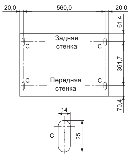
Рис. 56 Шаблон для сверления под подставку (мм)
